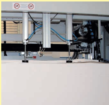
Schüttelanlage BASA: Die Mengenbestimmung erfolgt automatisch nach Höhe der Lagen. Ein Zählen der Bögen entfällt.
