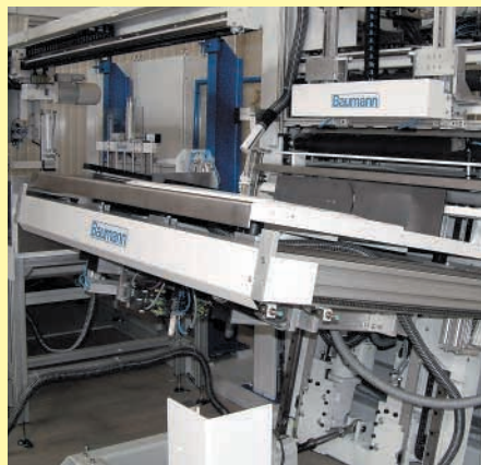
Die BASA verarbeitet den Stapel ohne Bedieneringriff und liefert geschüttelte, ausgerichtete Lagen an die Schneidanlage.
