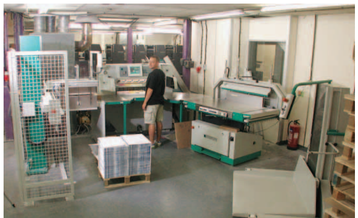
Schneidstraße der Perfecta Schneidemaschinenwerk GmbH für den kleinformatigen Bereich.
