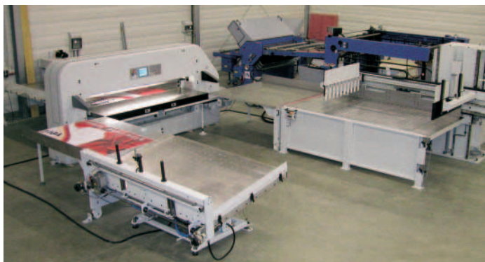
Die Schneidanlage Senator E-Line 260 mit geöffneten Transfertischen während des Schneidvorgangs.
